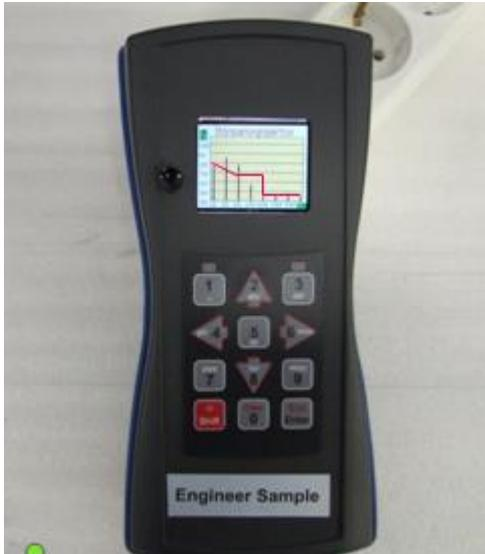
**Netzanalyse – Handgerät NA 02-13
